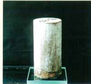
マスキングシリカが形成されたモルタル供試体表面の10年間の不溶性被膜
